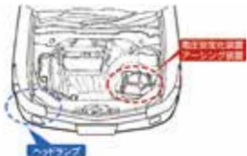
バッテリー付近に取付ける後付電装品（電圧安定化装置、HID ヘッドライト等）の起因による火災や製品の不適切な取付けが原因と推定される火災が発生しています。このような後付製品を購入する場合には、取付ける際の注意事項を確認しておきましょう。
